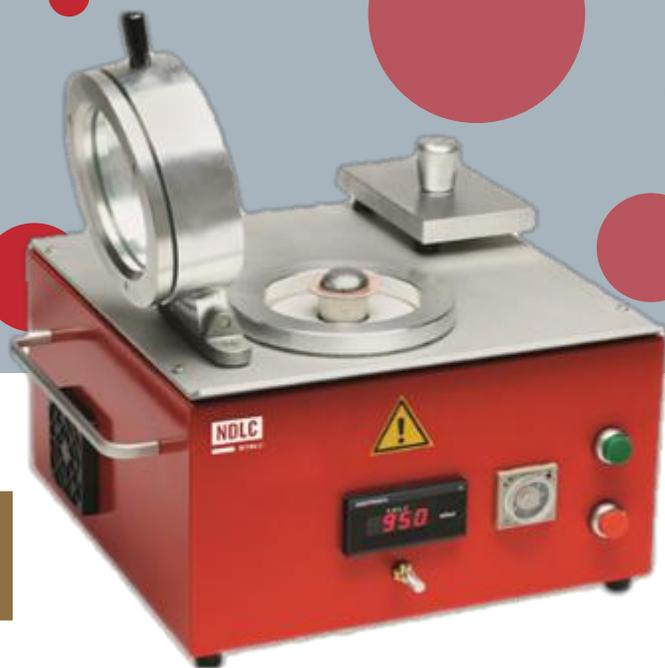
为了创建具有可调最终真空度的低压密度样品，必须为两个密度样品制备密度指数。一种样品在大气压力下固化，另一种样品在真空室内固化。两种样品都经过自动密度天平两次测量，可以自动计算密度指数。
