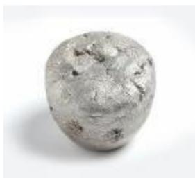
浮渣测试用于确定非金属夹杂物（氧化物）。
