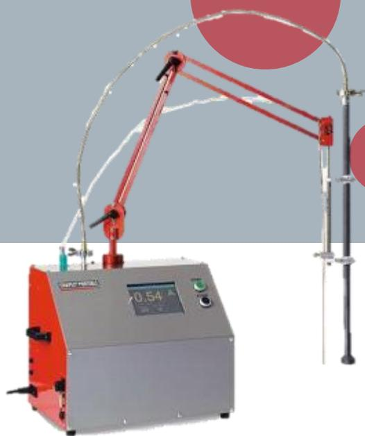
CHAPEL® PORTABLE可以测量液态铝中的氢含量。是全球唯一可以直接测定并连续进行氢含量的测量设备。该设备因其紧凑和易于操作而与众不同。在中心有两个单独的用户界面，通过它们可以轻松操作设备。CHAPEL® PORTABLE石墨探头在液态金属中像人造气泡一样反应。由于其出色的抗温度冲击性能而使其出色。此外，它的预期寿命超过一年，并且在铝熔体中具有出色的电阻率。实现数据存储和向PC传输的多种可能性（RS232，以太网连接，USB）。
