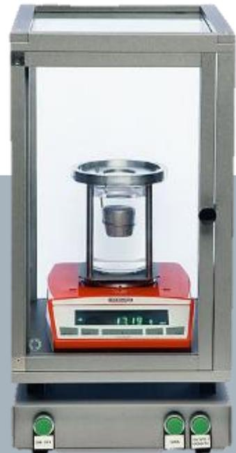
自动密度天平+振动保护+坚固的房屋
