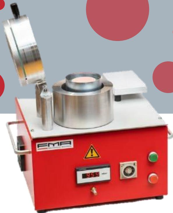
带有特殊真空室的低压密度样品装置，用于密度、金属和非金属夹杂（Dross）测试
